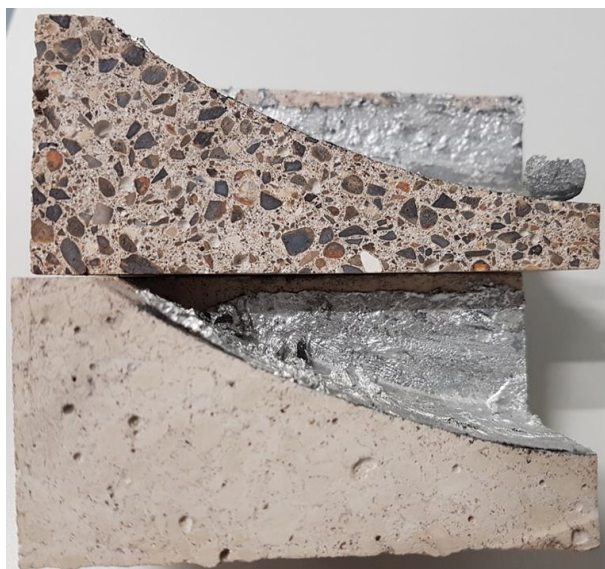
Figura 9: Imágenes de los resultados obtenidos en el ensayo de contacto con la aleación 7075 de Al
